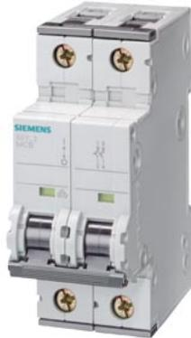
Interruttore magnetotermico 400V 6kA, a 2 poli, C, 10A, P=70mm
