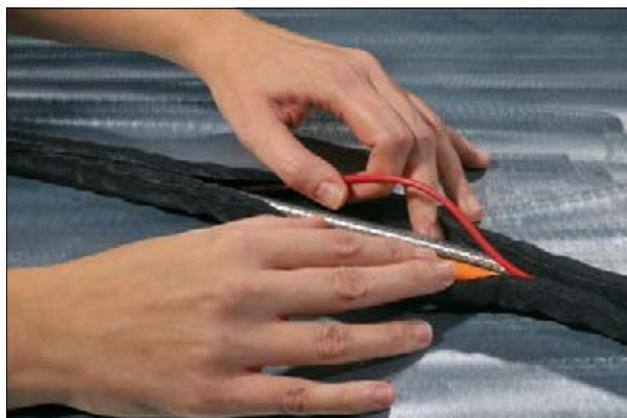
Helagaine Twist-In garantisce un facile accesso ai cavi e ai fili per l'ispezione, la manutenzione e l'assemblaggio.
