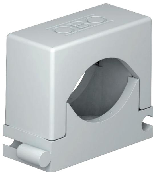
Gaffetta universale per il fissaggio individuale di cavi, tubazioni e tubi, tutte le dimensioni possono essere accoppiabili tra loro a piacere, con piedino di fissaggio adesivo, asola e per filettatura M6. Per l'incollaggio dei morsetti in poliammide su strutture in muro e calcestruzzo utilizzare la colla a presa rapida per passerella Impu-Fix tipo 509.
