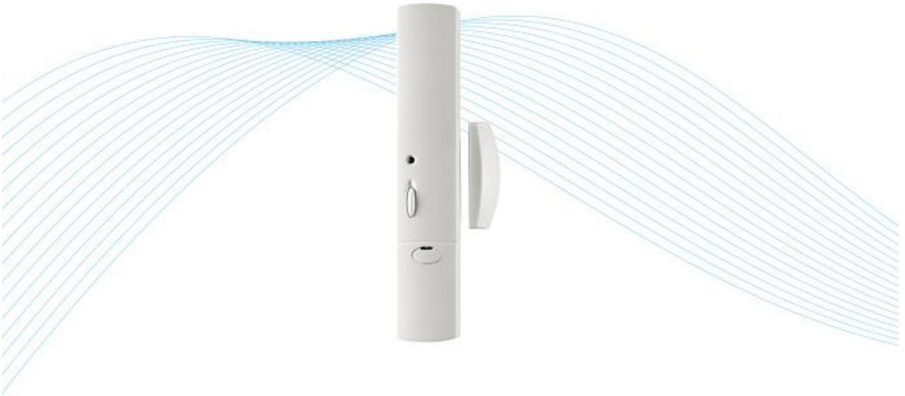
Il rivelatore di apertura **RLA004T** di colore bianco è composto da due parti: un trasmettitore con sensore reed incorporato ed un magnete.
