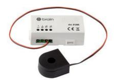
Dispositivo per la misurazione dell'energia e della potenza istantanea: i dati possono essere consultati tramite l'App Brain. Inoltre, nel caso di installazione in presenza di Placca o Frutto Ipersenso, è possibile essere allertati in caso di sovraccarico di tensione ed evitare il blackout spegnendo gli elettrodomestici, o altri carichi, secondo una sequenza prefissata.
