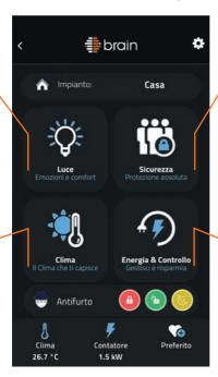
**CLIMA**: Misura in tempo reale temperatura e umidità, con regolazione dei parametri di climatizzazione per ogni ambiente tramite profili programmabili di temperatura settimanali, giornalieri o con l'innovativa funzione Autoapprendimento
