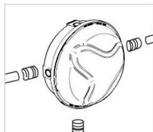
Sistema di canalizzazione con 3 ingressi cavo sfondabili periferici per pressacavi PG9 o PG13,5; 1 ingresso sul fondo per passacavo.
