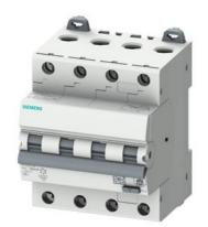
RCBO, 6 kA, 4P Type A, 30 mA, C-Char, In: 10A Un: 400V
