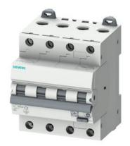
RCBO, 6 kA, 4P Type A, 30 mA, C-Char, In: 25A Un: 400V Energy limiting class 1: check for normative use limitations
