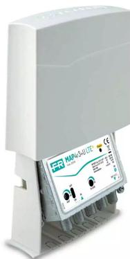
**Amplificatore con 2 ingressi (FM+III+DAB, UHF) da palo con guadagno 28dB e livello di uscita fino a 116dB $\mu$ V in banda UHF, amplificazioni separate VHF/UHF, regolazioni del guadagno (0-15dB) indipendenti per ogni ingresso e bassa figura di rumore. 2 uscite e filtro 694MHz 5G e 4G LTE integrato.**
