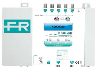
**Centrale programmabile** per il filtraggio altamente selettivo dei canali televisivi con **5 ingressi** (FM, 4x VHF/UHF flessibili) e livello di uscita 113dB $\mu$ V per ciascun filtro. **32 filtri da 1 a 6 canali**, ciascuno con 8 livelli di selettività.
