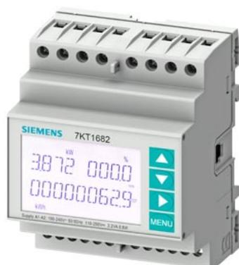
SETRON, dispositivo di misura, 7KT PAC1600, LCD, L-L: 400 V, L-N: 230 V, 5 A, apparecchio per montaggio su guida DIN, trifase Misura multifunzione incl. THD, AC/DC, morsetto a vite
