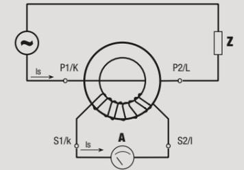
Nel collegamento di tutti i trasformatori amperometrici è importante rispettare i sensi di percorrenza della corrente.
