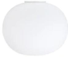
Apparecchio di illuminazione da soffitto a luce diffusa. Diffusore composto da un vetro opalino incamiciato, soffiato a bocca, con finitura esterna acidata e da una ghiera filettata in lega di alluminio pressofusa, con finitura galvanica "cromatazione alodine". Attacco a plafone composto da un elemento stampato ad iniezione in poliammide rinforzato con il 30% di fibra di vetro e supporto diffusore in lega di alluminio pressofusa verniciato di colore grigio a liquido.
